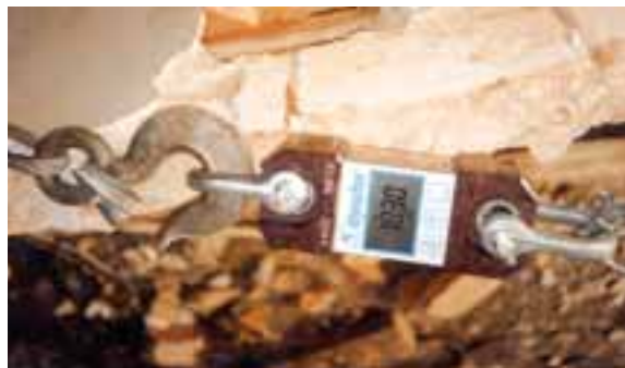
Fig. 7 – Ensaio destrutivo de arrancamento, realizados in situ . (a) Sistema de carga; (b) Célula de carga.
