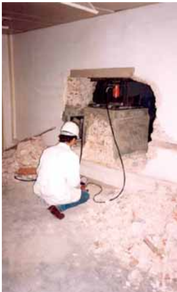
Fig. 6 – Ensaio de corte destrutivo.
