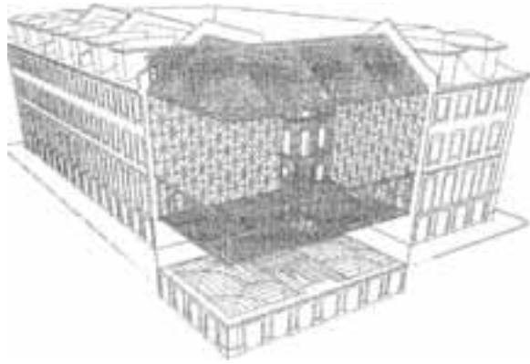
Fig. 13 – A estrutura de madeira assenta no embasamento de pedra.
