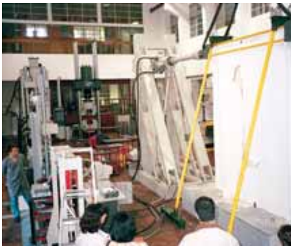
Fig. 9 – Painel de frontal pombalino pronto para ensaio e sistema de carga utilizado.
