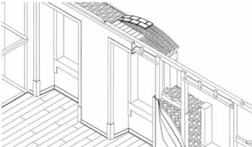
Fig. 5 – Corte perspectivado pelo interior de parede exterior.
