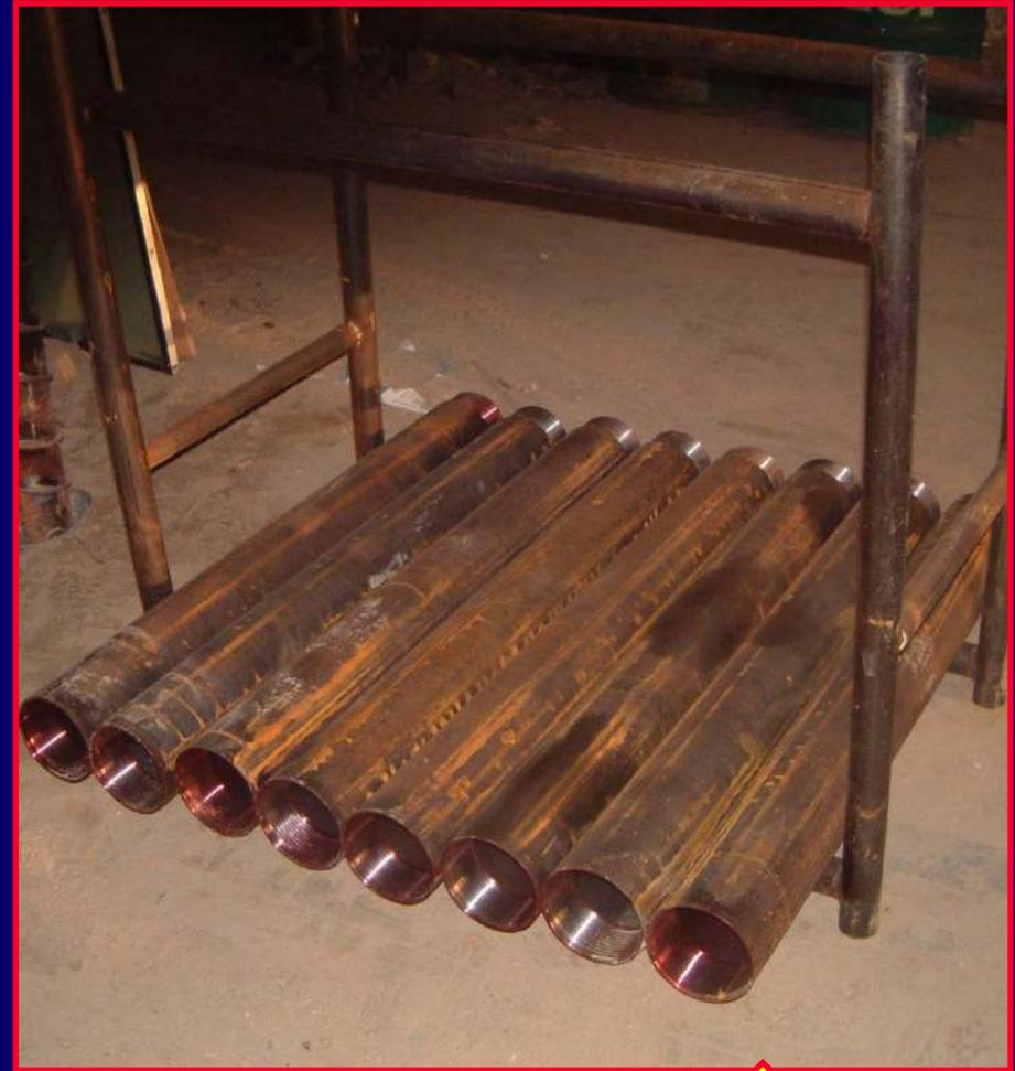
Tubos das microestacas utilizadas nas soluções de contenção e recalçamento ( $\lambda < 120$ ;  $N=15\% N_{ult}$ )
