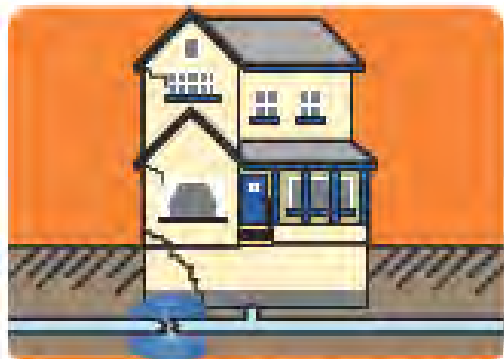
Roturas em condutas
